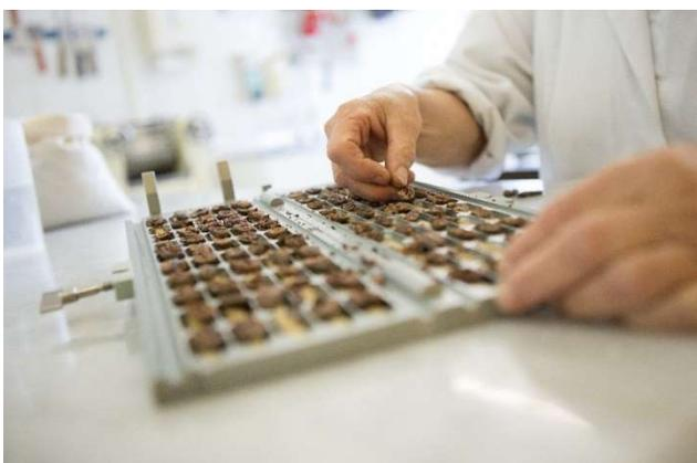
*Beim Schnitttest wird die Qualität der Kakaobohnen überprüft*
