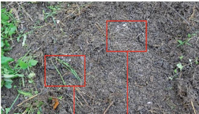
**Nach 60 Tagen** waren nur noch minimale Spuren in Form von silbernen Stellen sichtbar. Bei der Vergrößerung der roten Felder sieht man noch letzte Spuren der ursprünglich vier Folien. Würde der Komposthaufen nun fachgerecht aufbereitet, wären keine Spuren mehr sichtbar. Die Heimkompostierbarkeit konnte unter einfachsten Bedingungen nachgewiesen werden.
